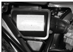
Imagen 17. Filtro de aire.
