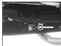
Imagen 15. Ubicación del tornillo de drenado.
