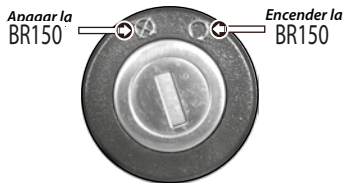
Imagen 7. Interruptor de encendido.
